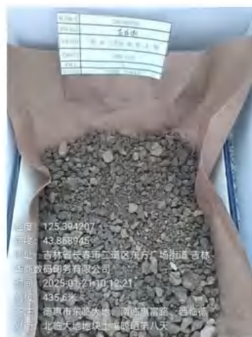
土壤样品 T5 晾晒第 8 天(可制备土样)
